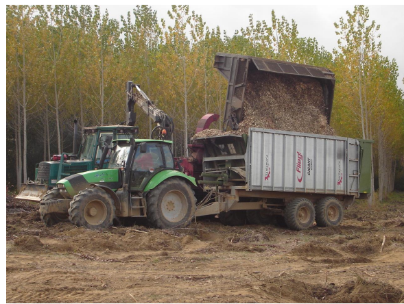
Detalle del volcado del contenedor para la obtención de la astilla procesada
