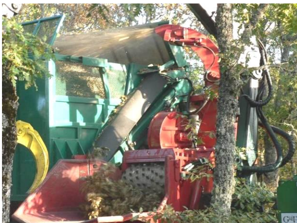
Detalle del rodillo y de la mesa lateral de alimentación
