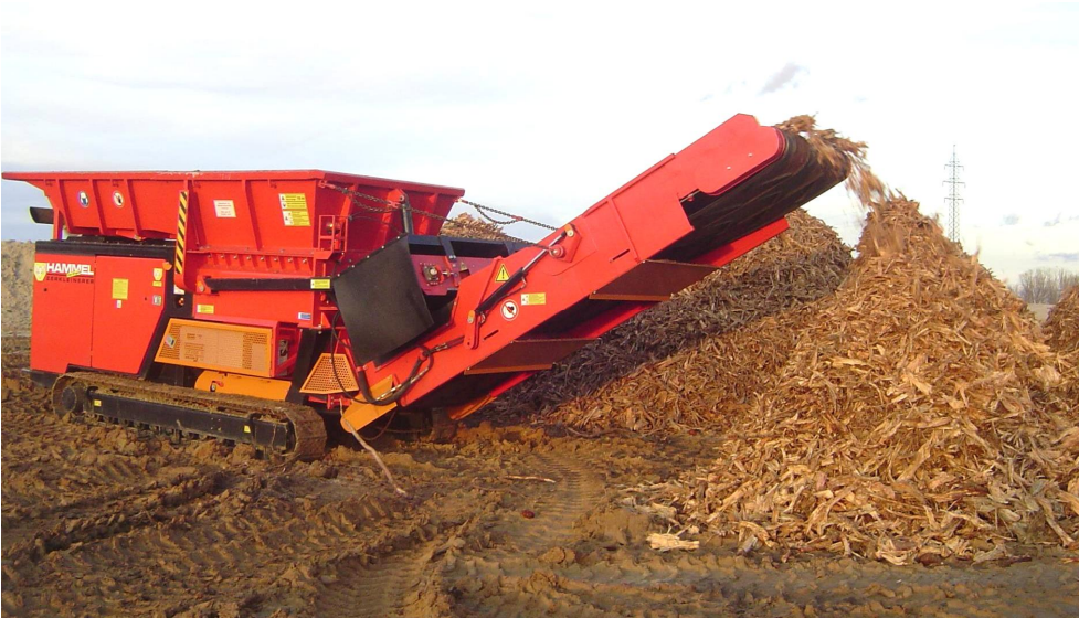
Pre trituradora 350 CV (12 tm/h)
