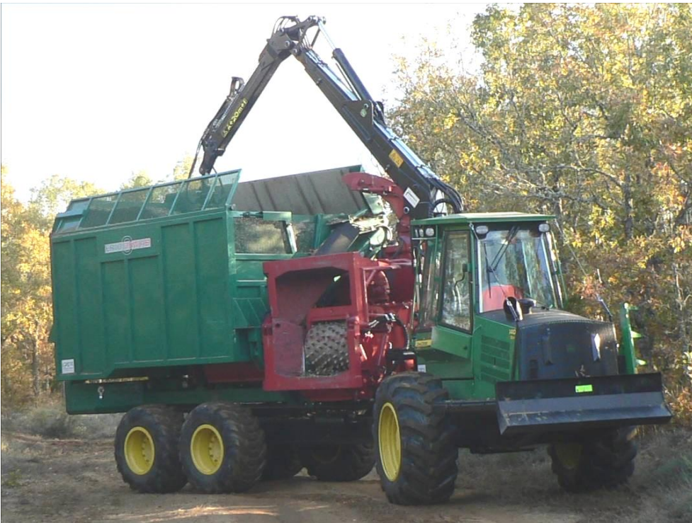
Astilladora autopulsada 450 CV + 150 CV (20 Tm/h)
