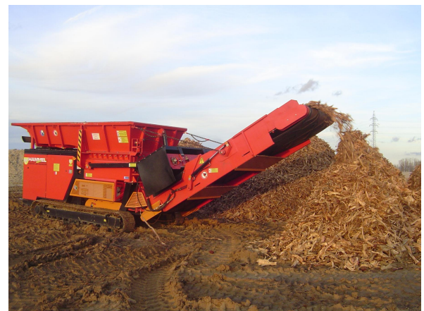
La cinta transportadora permite crear pilas de astillas de 3 metros de altura o cargar directamente en contenedor
