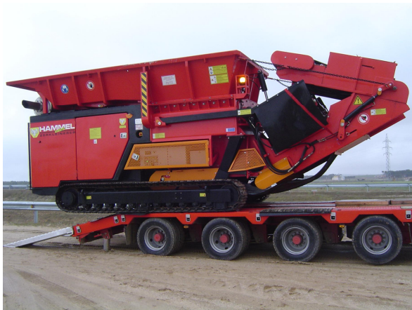
La máquina se transporta sobre góndola y dispone de su propio sistema de tracción
